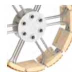
Figura 3. Vista de los alerones laterales a la pista central y que amplían la superficie de rodadura de las ruedas del rover
